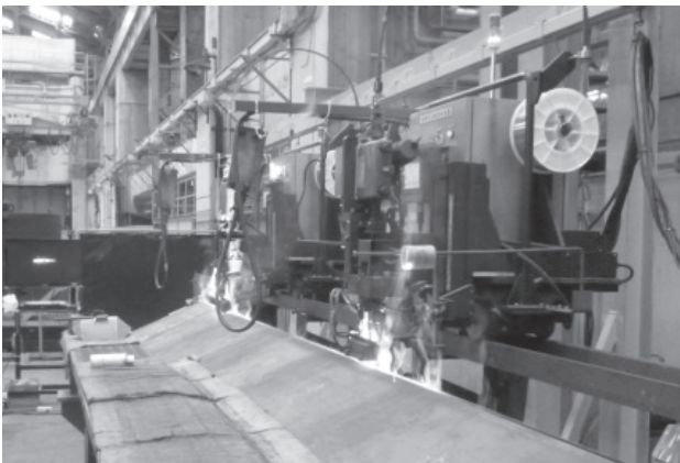
写真4 タンデム狭開先自動溶接の状況
