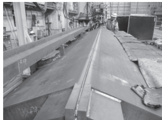
写真3 溶接速度適応制御結果の一例
